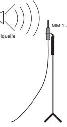
MM 1 deshalb so aufstellen, dass die Mikrofonachse um 90° zur Schallquelle steht. Dadurch wird auch bei Frequenzen oberhalb 10 kHz eine exakt lineare Wiedergabe erzielt.
